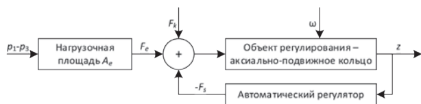
Рис. 6. Модель импульсного уплотнения как системы автоматического регулирования
