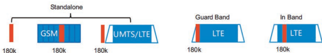
Рис. 3. Варіанти реалізації NB-IoT: режими stand-alone (окремий радіочастотний канал / смуга); in-band (внутрішньо-смуговий режим); guard-band (режим реалізації у захисній смузі) [8]
