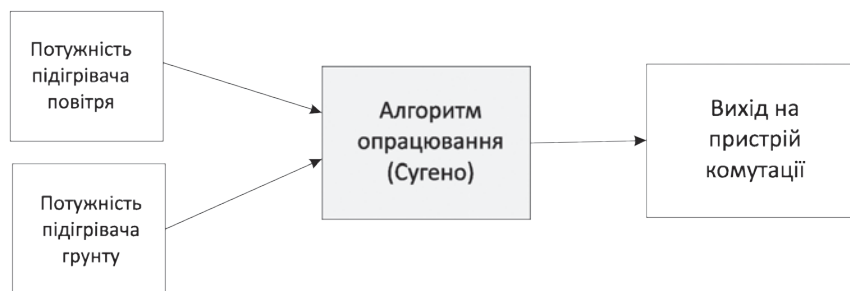
Рис. 2. Структура нечіткої АСК температурно-вологісним режимом (модуль FIS-Editor MatLab®)
