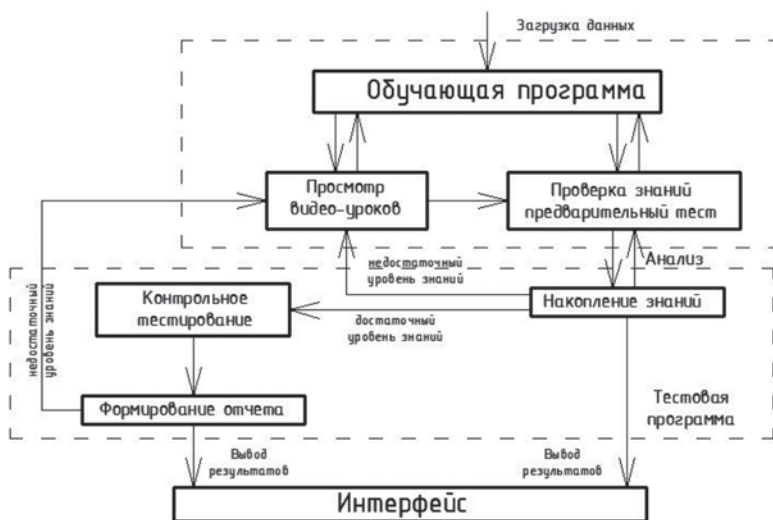
Рис. 2. Функциональная схема системы дистанционного обучения
